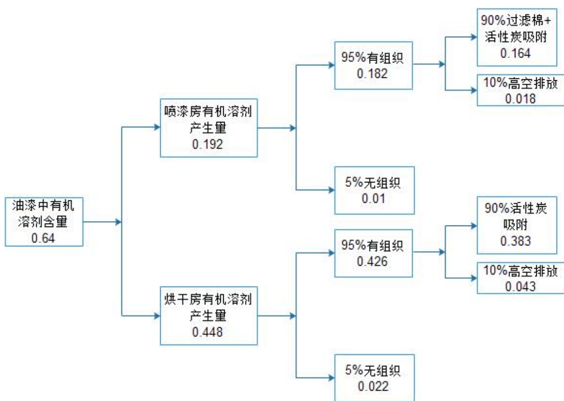
图 5-1 物料平衡图 (t/a)
