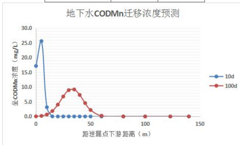
图 6-1 泄漏后污染物在地下水中迁移预测结果
